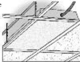
5) Pour les conduits de chauffage et de climatisation, prolongez-les jusqu'à la hauteur du nouveau plafond, coupez un trou dans le panneau et installez la grille de ventilation.
