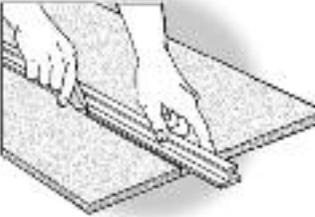
3) Pour contourner une colonne, mesurez son diamètre et tracez sa position sur le panneau, ensuite, coupez le panneau de la façon illustrée.
