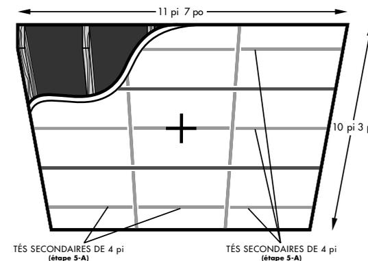
**B) Panneaux 2 pi x 4 pi orientés perpendiculairement aux tés principaux**
