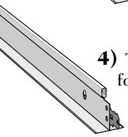
**4) TÉ SECONDAIRE :** Ce profilé également en forme de T, de 2 pi ou 4 pi de longueur, permet de construire les cadres nécessaires au support des quatre côtés de vos panneaux.
